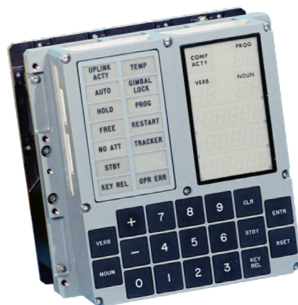
Apollo Guidance Computer, c'est l'ordinateur utilisé par la mission spatiale Apollo en 1969 pour aller sur la Lune. Il avait une capacité de stockage de 36000 mots soit 72 kilooctets et une RAM de 4 KO. Aujourd'hui, une seule et simple question sur un moteur de recherche équivaut à toute la puissance de calcul utilisée en vol et au sol au cours du programme spatial, qui a duré pendant 11 ans.
